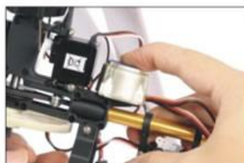
8. 将陀螺仪固定好 Fix the GYRO.
