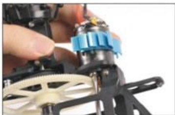
1. 把马达固定在机身上 Fix the motor on the body
