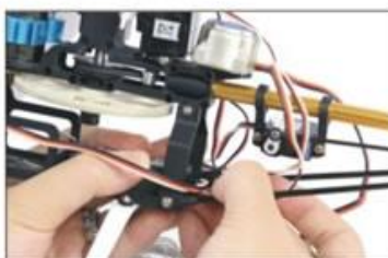
14. 将陀螺仪连接在第四通道 Connect the gyro with CH4.
