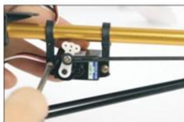
7. 将方向伺服器固定 Fix the rudder servo.
