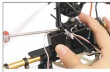
3. 将螺距伺服器固定 Fix the pitch servo.
