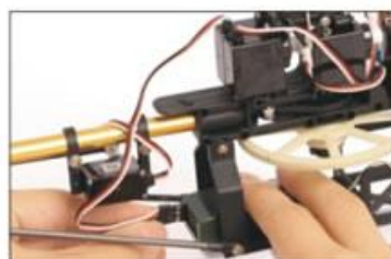
10. 将左右副翼伺服器连接在第一通道 Connect the left & right AIL servo with Ch1
