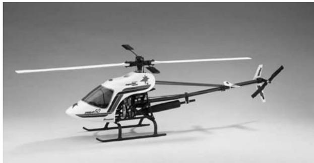
Als Programmierbeispiel dient der Hubschrauber STARLET 50 von GRAUPNER, mit 3 um jeweils 120° versetzte Anlenkpunkte, Einsteigerabstimmung ohne erhöhte Gaskurve, ohne senderseitige Kreiselbeeinflussung und ohne Drehzahlregler. Bewusst wurde diese einfache Programmierung gewählt, auch um zu demonstrieren, dass mit relativ wenig
