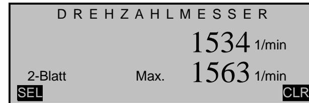
Mit dem als Zubehör unter der Best.-Nr. **4813** erhältlichen Drehzahl-Messsensor kann auf optischem Wege eine genaue Drehzahlmessung an 1- bis 20-Blatt-Luftschrauben, Rotorblättern oder Impellerrotoren berührungslos durchgeführt werden.
