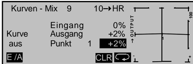
In der Endstellung des 3-Stufenschalters, bei voller Leistung (Eingang = +100%), benötigt beispielsweise das Modell einen anteilig stärkeren Momentenausgleich, weshalb Punkt „H“ und damit auch der Ausgang zum Höhenruder auf einen Wert von 6% gesetzt sind (was dem Mischanteil eines Linearmischer entsprechen würde):
