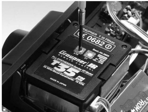
Der linke Kanalselektorschalter am Modul bzw. am Empfänger ist mit dem Multiplikator „x10“, der rechte mit „x1“ gekennzeichnet. Es können aber nur die gemäß der Frequenz- und Kanaltabelle, Seite 208, in
